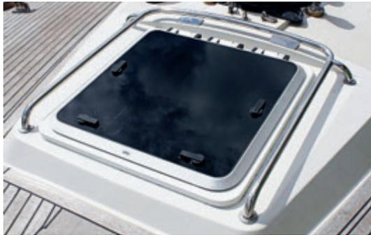
Extra starke Scharniere ermöglichen das stufenlose Öffnen bzw. Festhalten in jeder Stellung bis zu 180°. Die Leicht-/oder Schwergängigkeit des Öffnens oder Schließens des Lukendeckels erfolgt problemlos am Scharnier.
