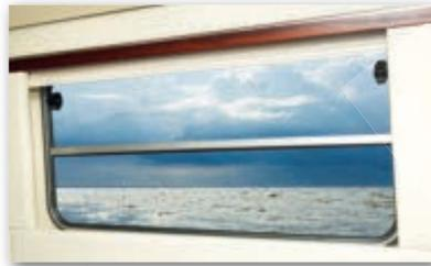
Das Glas gleitet über einen speziellen Gummi. Wasser wird über eine interne Drainage nach außen geleitet. Das Fenster kann in jeder Öffnung festgestellt werden
