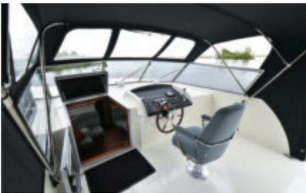
Gebo Windschutzscheiben haben den qualitativ hochwertigen Standard wie Schiffsfenster. Die Basis bildet eine sichere Konstruktion, die eloxiert oder pulverbeschichtet werden kann. 5 oder 6 mm Glasstärken sind als getöntes Glas oder Klarglas erhältlich. Auf Wunsch kann mit Bohrlöchern
