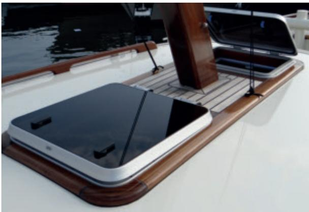
Die Leicht-/oder Schwergängigkeit des Öffnens oder Schließens des Lukendeckels erfolgt problemlos am Scharnier. Gebos Luken bieten eine perfekte Lüfterstellung. So kann die Luke wenig geöffnet arretiert werden und ermöglicht eine optimale Luftzirkulation, auch wenn Sie nicht an Bord sind.
